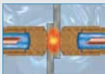
本図は、溶接ナゲットがどのようにして形成されるかを示します。溶接ガンのチップは素早く閉じてから部品に接触するにつれて部品の衝撃の低減のためゆっくりと「ソフトタッチ」の速度になるよう設計されているため、より高品質な溶接となります。
