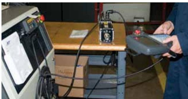
最終システムテストによりフィードバックデバイスがGSWAモーターの両極と適切に並んでいるかを確認します。
