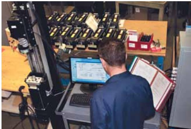
350サイクルでの機能ユニット検査は、ストローク、長さ、無負荷トルク、入力電流対力標準偏差を量化します。
