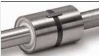
重荷重を処理可能。力は、微細なねじ付きローラーねじでかみ合うマルチねじ付きヘリカルローラーアセンブリによって伝達されます。ローラーねじには、多くの接触点に基づいて特別の負荷能力があります。
