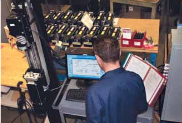
Die Funktionsprüfung über 350 Zyklen misst Schubkraft, Länge, Leerlaufdrehmoment, Eingangsstrom zu Standardabweichung der Kraft.
