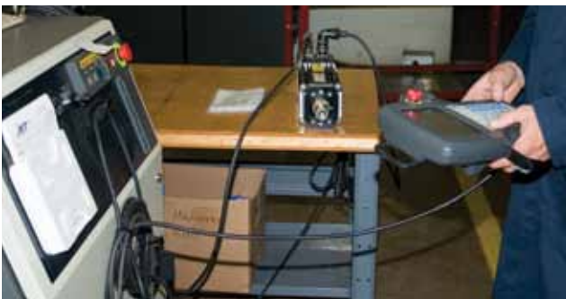
Die abschließende Systemprüfung stellt sicher, dass die Feedback-Einrichtung genau an die Pole des GSWA-Motors angepasst ist.
