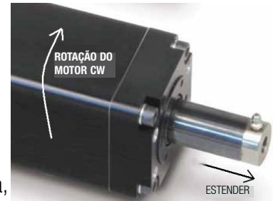
Figura 2.3.2.1: Movimento da haste de impulso em relação à rotação do motor
