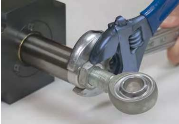
Hình 2.7: Giữ cố định trục đẩy sử dụng cò-lê trên bề mặt phẳng trên đầu cuối của trục khi kết nối phụ kiện, nối trục hay nối tải với động cơ. Hai cò-lê được sử dụng trong trường hợp này: một cái dùng để ngăn trục đẩy xoay, một cái để khóa chặt khớp nối cầu.
